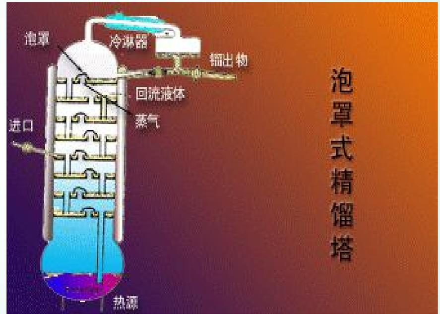
精馏塔有多种类型，如图所示是早期用的泡罩式塔板状精馏塔的示意图。
