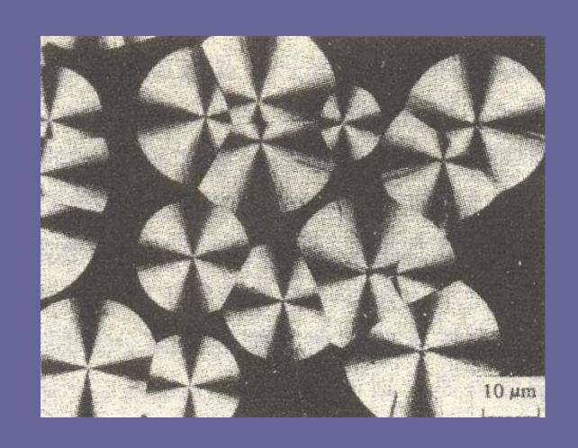
全同立构聚苯乙烯球晶的偏光显微镜照片
